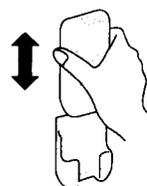
Для установки или снятия пульта дистанционного управления поднимите его или опустите его в держатель.
