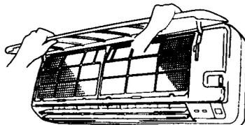
При установке воздухозаборной решетки надежно вставьте крепежные рычаги в основной прибор и закройте решетку.
